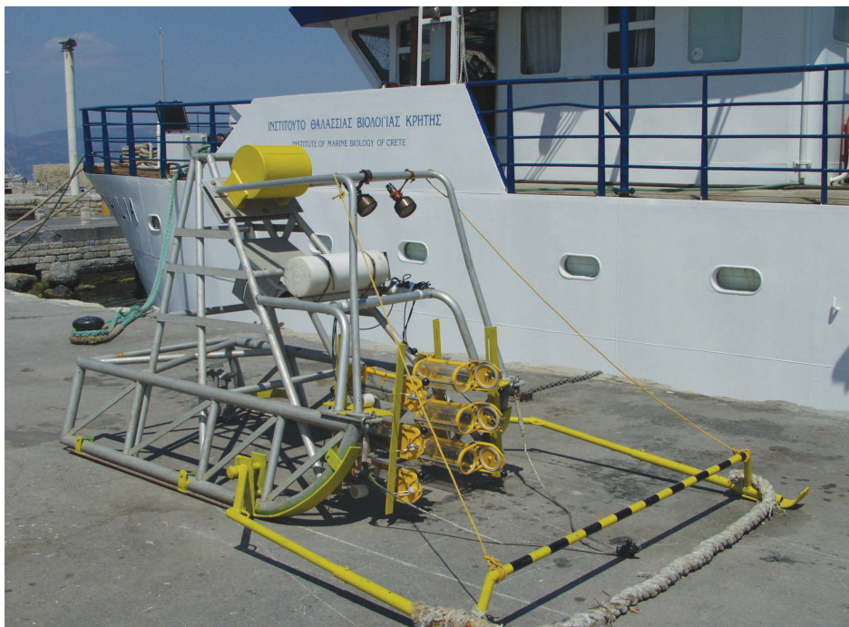
Ειδικό έλκηθρο - δειγματολήπτης βυθού μπροστά από το ερευνητικό σκάφος “Φιλία”.
