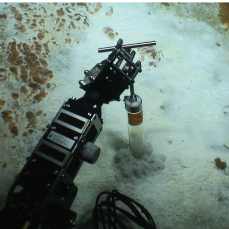
Υποθαλάσσια δειγματοληψία με χρήση βαθυσκάφους τηλεχειρισμού (ROV) για μοριακές μικροβιακές αναλύσεις.
