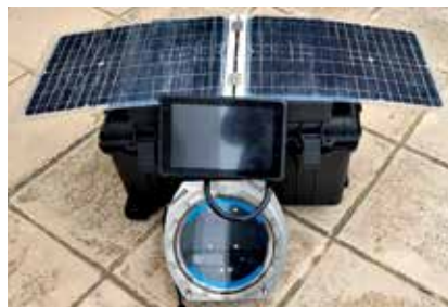
Στερεοσκοπική κάμερα για την εκτίμηση του μεγέθους των ψαριών.
