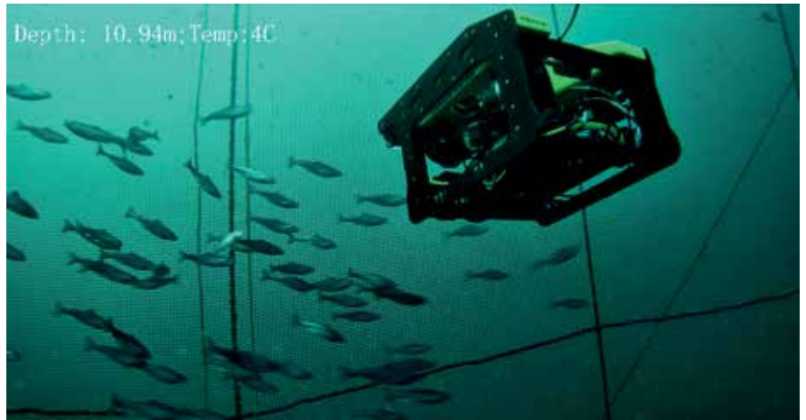
Έλεγχος δικτύων ιχθυοκαλλιέργειας από τηλεκατευθυνόμενο υποβρύχιο όχημα (Remotely Operated Vehicles) [ROV], φωτογραφία SINTEF.
